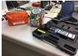
車両基地に配備されているWBGT指数計と熱中症対策セット
