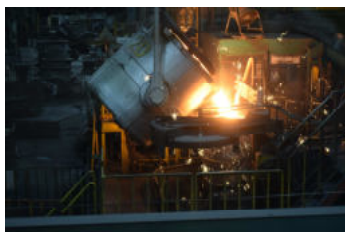
鋳鉄管の型に注がれる溶鉄
